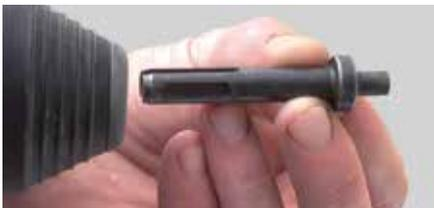
1. Postavite alat za ugradnju u glavu bilo koje SDS bušilice.
