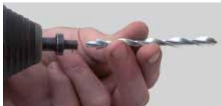
2. Postavite Airtwist pričvršćivač na kraj alata za instalaciju.
