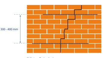
Nota – Dettaglio 4: La maglia in acciaio Inox per malta viene usata per riparare muri con cavità vuote. Andare al dettaglio 4 se dovete riparare un muro solido.
