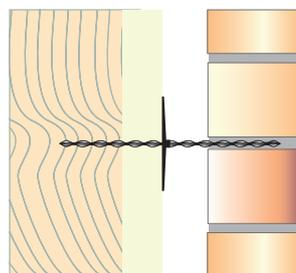
2. Enfiler la rondelle de plaquage, celler SURETWIST dans la maçonnerie.
