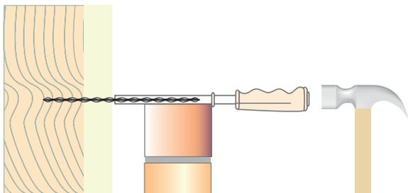
1. Placer SURETWIST dans le tubulaire de frappe manuel comme indiqué ci-dessus. Traverser l'isolant pour pénétrer dans le panneau de bois.
